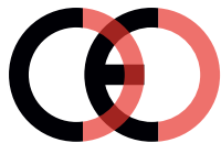
Falsche CE-Kennzeichnung (zu dicht)
